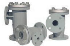
Der **Silo-Einlaufstutzen SE** wird überall dort eingesetzt, wo Förderleitungen an Silokörper angeschlossen werden müssen. Durch ihn wird das Gas-Staub-Gemisch rechtwinklig abgelenkt und in den Behälter eingeführt.
